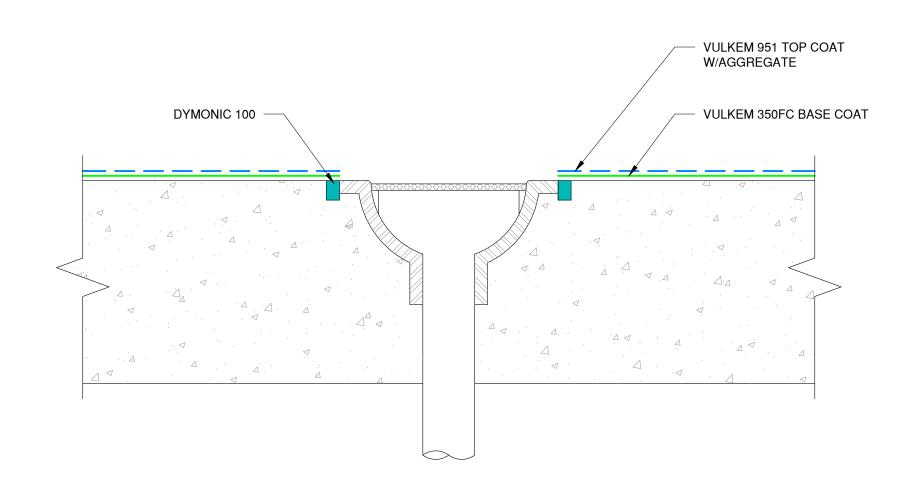
THERE ARE SEVERAL TECHNIQUES FOR INSTALLATION AROUND DRAINS. YOU MAY ALSO TAKE THE VULKEM MEMBRANE DOWN INTO THE DRAIN ASSEMBLY. THE DRAIN ASSEMBLY MUST BE BLOCKED IF THIS APPLICATION IS PREFERRED. THE METAL OR PLASTIC DRAIN SHOULD BE SCUFFED AND CLEANED AND PRIMED WITH TREMCO'S TREMPRIME NON POROUS PRIMER.
